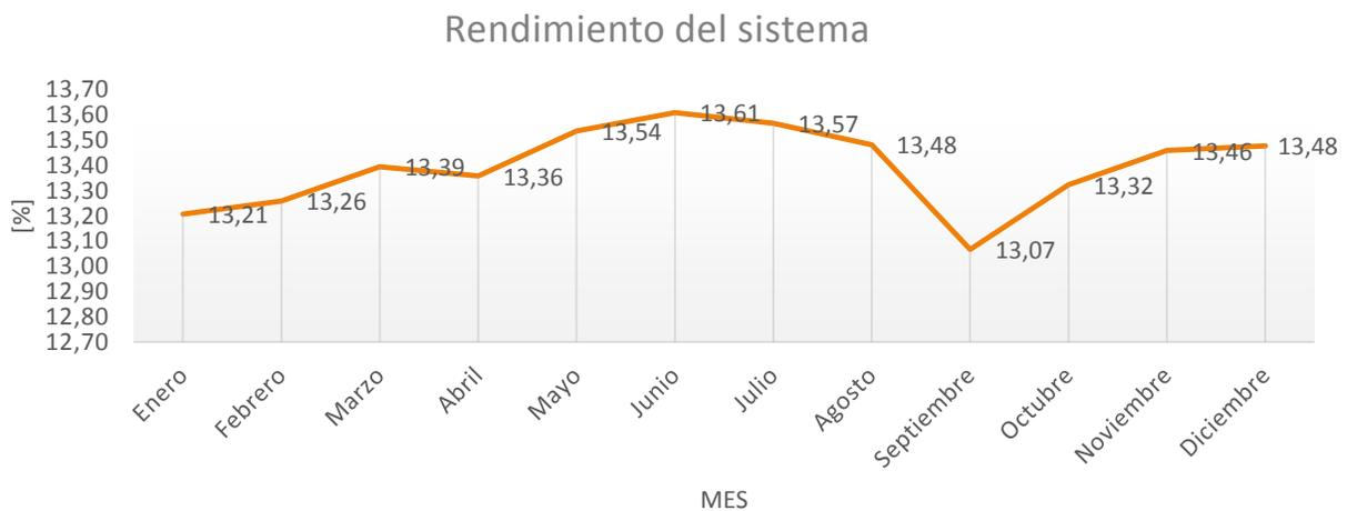
Figura 4: Rendimiento del sistema a lo largo del año. Resultado de la simulación del sistema con PVSyst.
