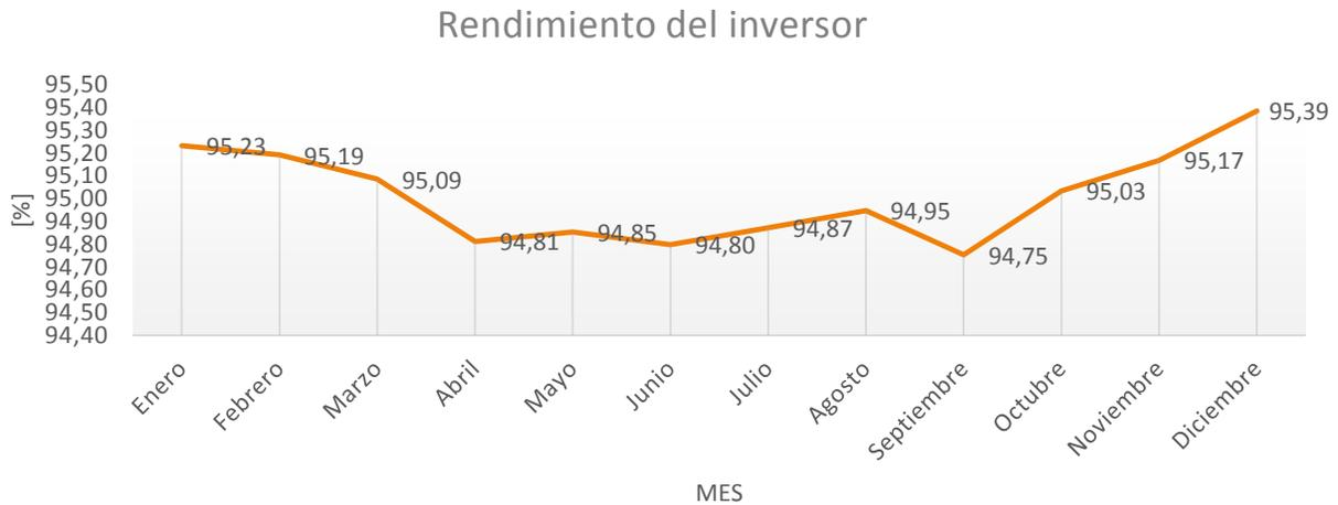
Figura 3: Rendimiento del inversor a lo largo del año. Resultado de la simulación del sistema con PVSyst.
