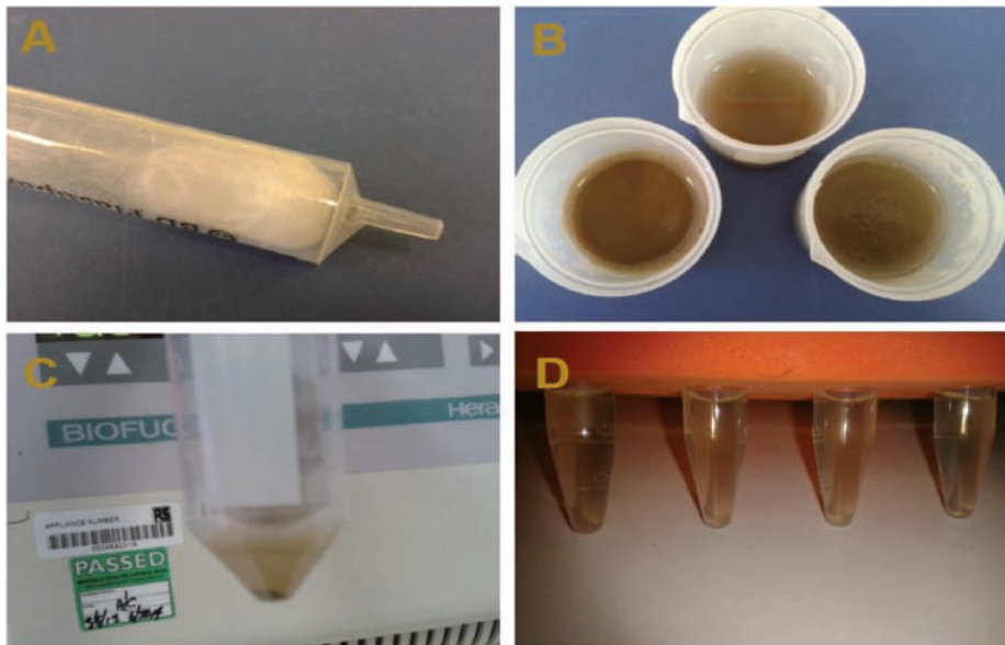
Figura 7. Obtención de extractos acuoso y metanólico. A. Cilindros de jeringa de 20 mL rellenos con fibra de vidrio. B. Mezcla del solvente (agua) y sedimentos. C. Líquido obtenido de la extracción. D. Extractos listos para su conservación.
