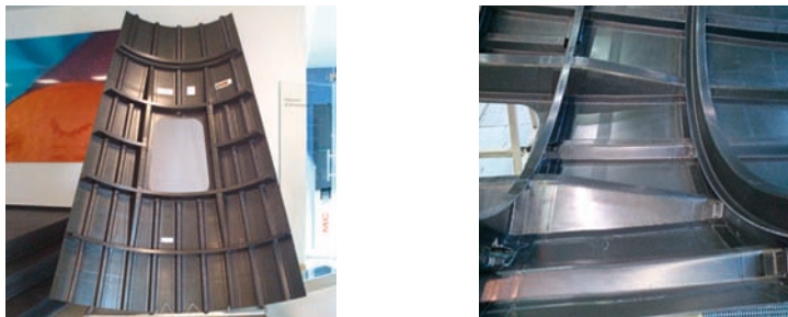
Figura 38. Estructura de fuselaje súper-integrada
