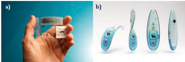
Figura 13. Dispositivos basados en grafeno: a) sensor de temperatura desarrollado por la empresa Thin Film Electronics ASA, b) teléfono móvil flexible desarrollado por la empresa NOKIA.
