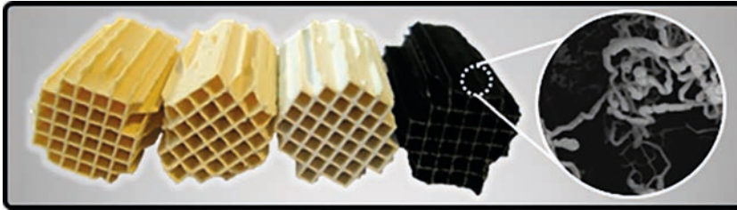
Figura 7. Distintas etapas en la preparación de monolitos de cordierita recubiertos con carbón. De izquierda a derecha: monolito de cordierita, recubierto con \gamma\text{-Al}_2\text{O}_3 , tras la deposición de Ni, tras el crecimiento de CNFs y detalle de las CNFs (imagen de SEM).
