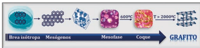
Figura 3. Esquema del proceso de carbonización/grafitización (Botas, 2013).
