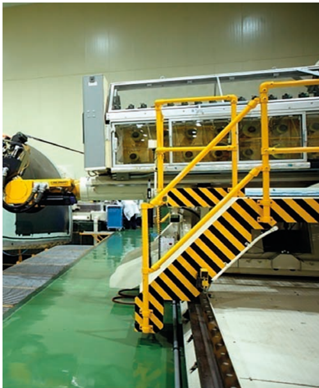
Figura 32. Fabricación automática AFP.
