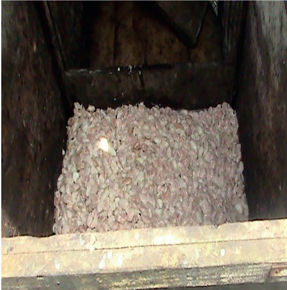
Imagen 1.6. Fermentación de cacao en cajones horizontales
