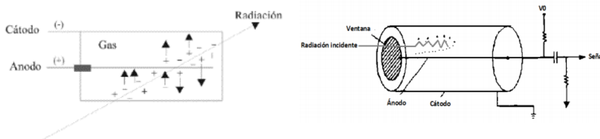
Figura 4. Esquema general de un detector de gas (izquierda) [Tucci, 2010], y partes básicas comunes de cualquier detector de gas [Delgado 2014].
