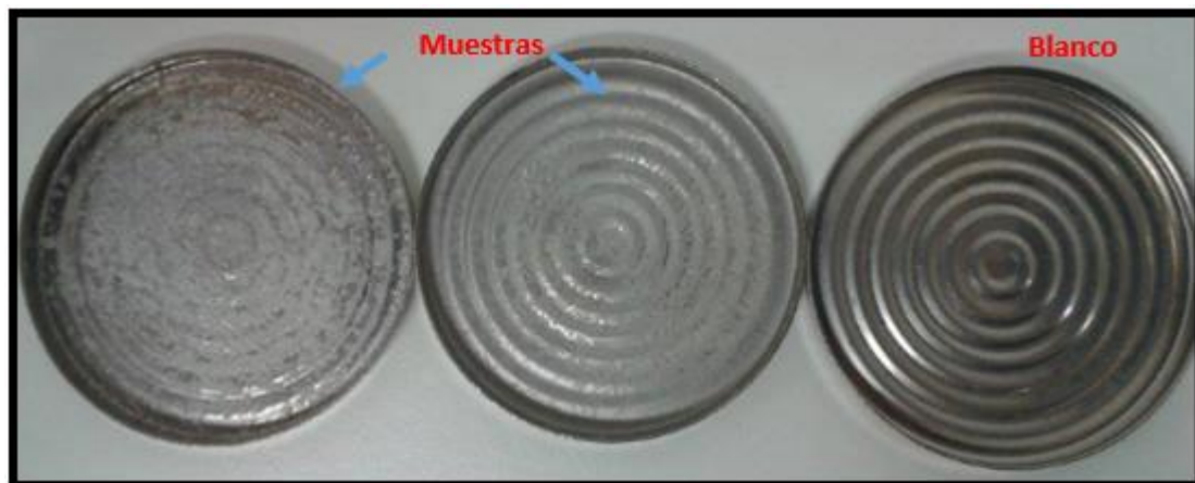
Figura 9. Presentación de tres planchetas, dos de ellas son muestras y la tercera solución blanco.
