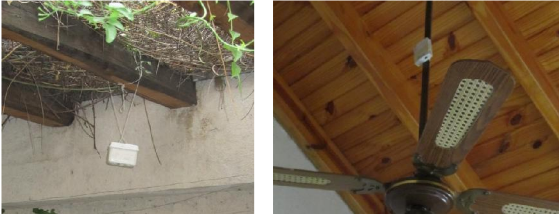
Fig.53: Fotografías de la ubicación de los sensores en la vivienda. Izquierda: Sensor exterior bajo la pérgola en la cochera. Derecha: Sensor en el dormitorio ppal. orientado al Sur. Fuente: Propia.
