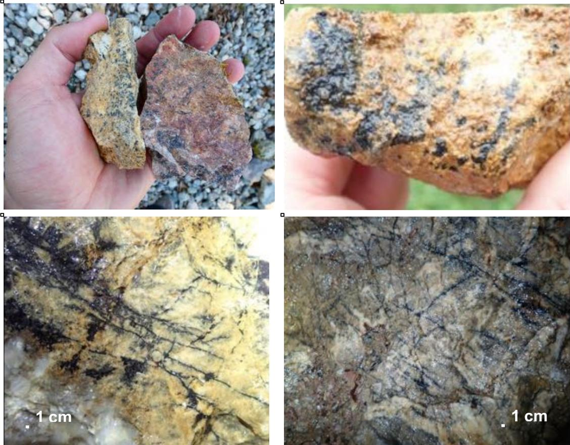
*Figura 9. Arriba, mineralización en forma de bolsadas y diseminada en la dolomía, escombrera Nivel 4 . Abajo, mineralización en venillas tipo stockwork, Nivel 4.*
