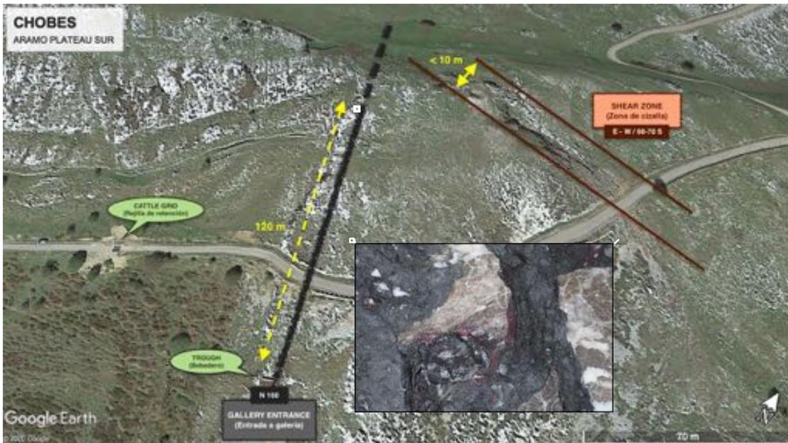
Figura 13. Caracterización de la Zona Chobes. En negro la proyección de la galería. Imagen de Eritrina en la zona de cizalla en el interior de la galería. Elaboración propia.
