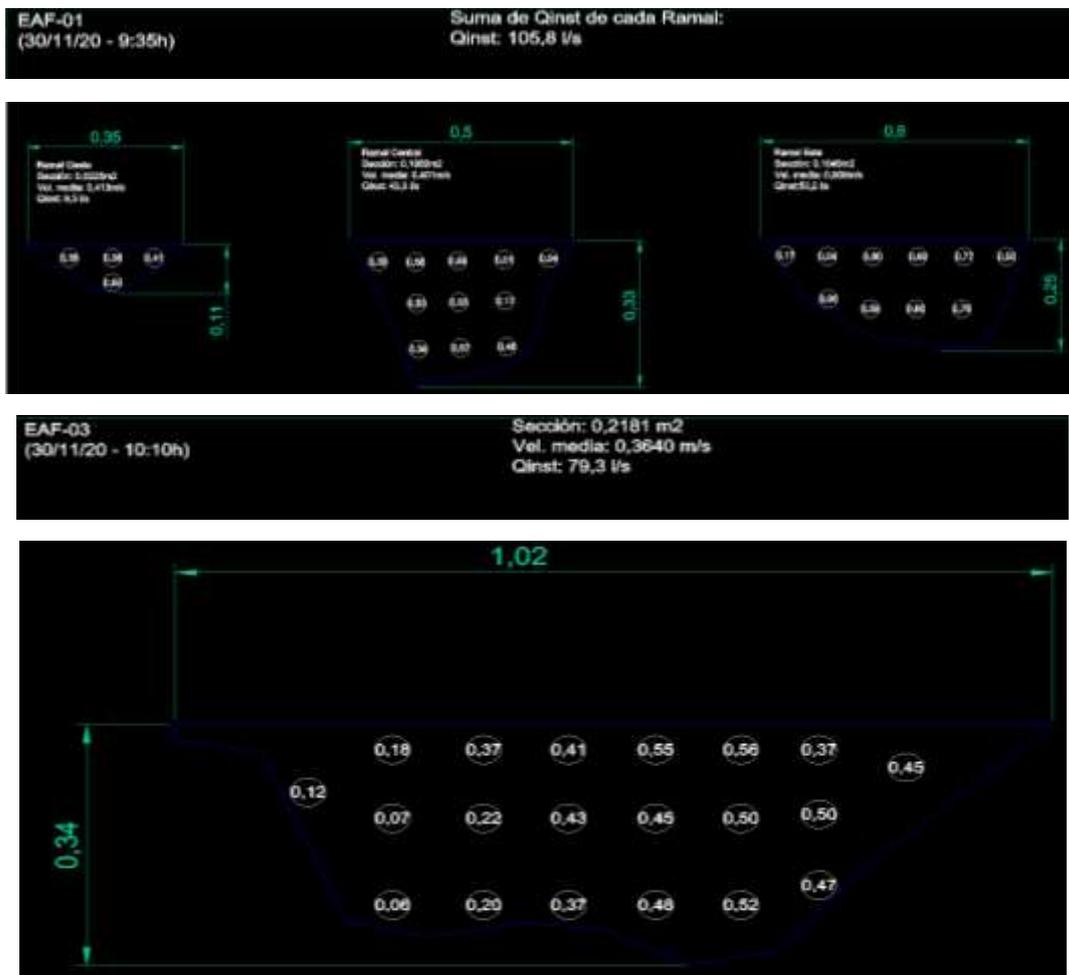
**Figura 13:** Ejemplo de medición de secciones con molinete en los puntos EAF-01 y EAF-03 elaborados con Autocad (Fuente: Minera Los Frailes).
