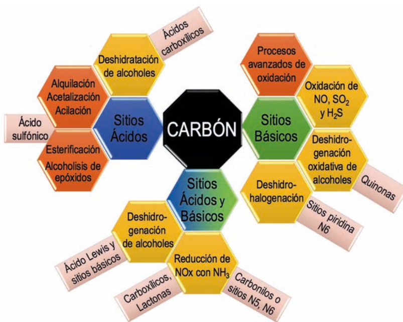
Figura 3. Reacciones catalizadas por materiales de carbón en fase líquida (color naranja) y gaseosa (color amarillo), así como sus correspondientes sitios activos. Adaptado de [29].
