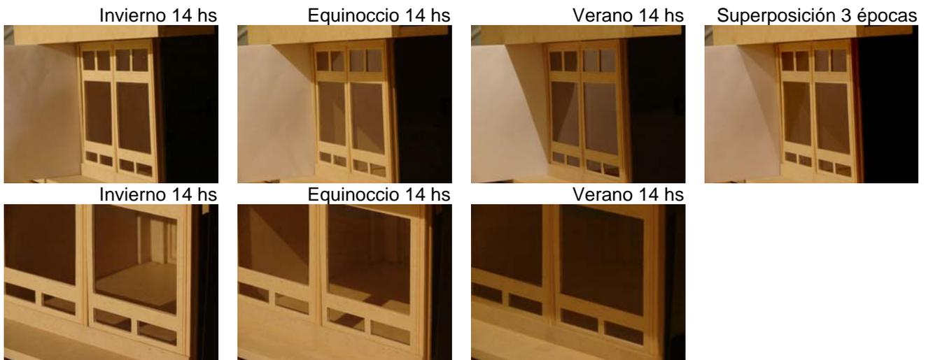
Figura 5.64 Registro fotográfico, en Laboratorio - Módulo con orientación NO. Detalles alero e interior 14 hs.
