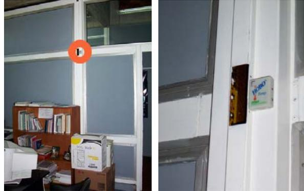
**Figura 5.28** Ubicación de datalogger Hobo, vista general y detalle en módulo MOD1-NE
