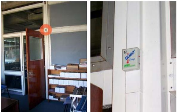
**Figura 5.30** Ubicación de datalogger Hobo, vista general y detalle en módulo MOD1-SE
