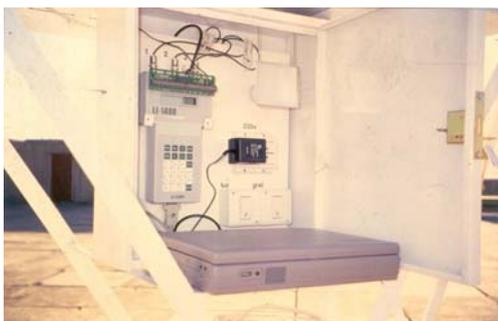
**Figura 5.31.** Datalogger receptor de datos de temperatura y humedad, registrados en la terraza del edificio en estudio.
