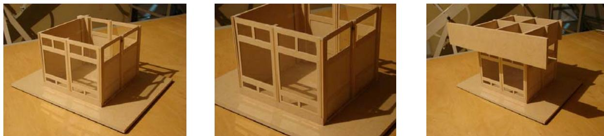
**Figura 5.50** Detalles de la maqueta del módulo para realizar estudios de asoleamiento e iluminación natural
