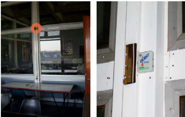
**Figura 5.29** Ubicación de datalogger Hobo, vista general y detalle en módulo MOD1-SO
