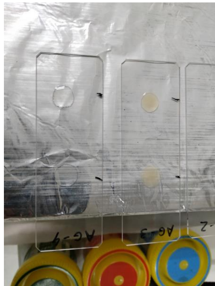
Figura 15. Proceso de elaboración de muestras permanentes, evaporación de agua de la muestra en placa calefactable a 60^\circ C
