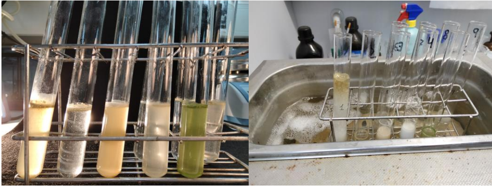
Figura 14. Proceso de oxidación de materia orgánica en la muestra con H_2O_2 en baño maría
